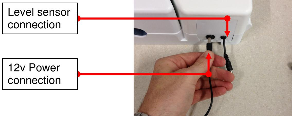
**MAKE SURE THE FLOAT SWITCH IS CONNECTED BEFORE THE POWER IS SWITCHED ON**
