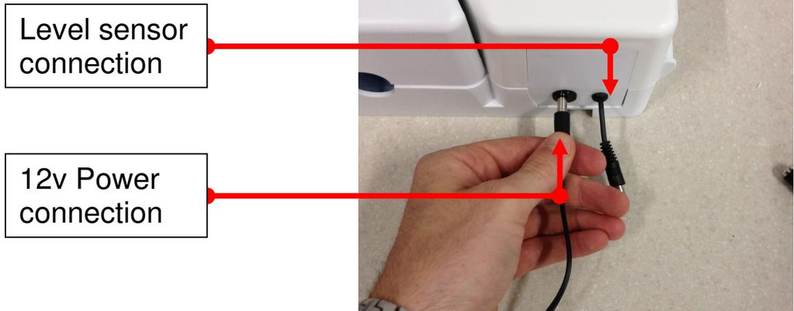
**MAKE SURE THE FLOAT SWITCH IS CONNECTED BEFORE THE POWER IS SWITCHED ON**
